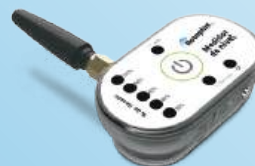
Monitor de nivel
